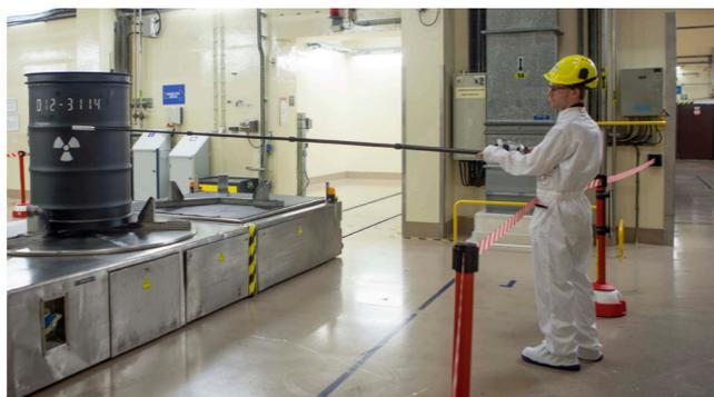
Les filtres à eau issus des circuits radioactifs, ainsi que les boues, sont stabilisés dans du béton qui est coulé dans des fûts spéciaux. Cette manière d'immobiliser les déchets est appelée « conditionnement ». Les fûts sont temporairement entreposés sur les sites avant d'être acheminés vers Belgoprocess.
