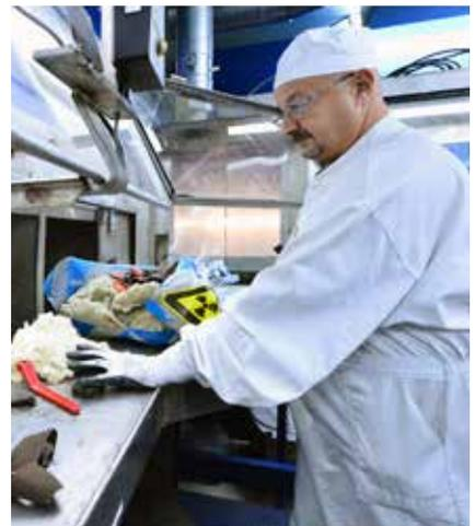
Tri des déchets faiblement radioactifs avant conditionnement
