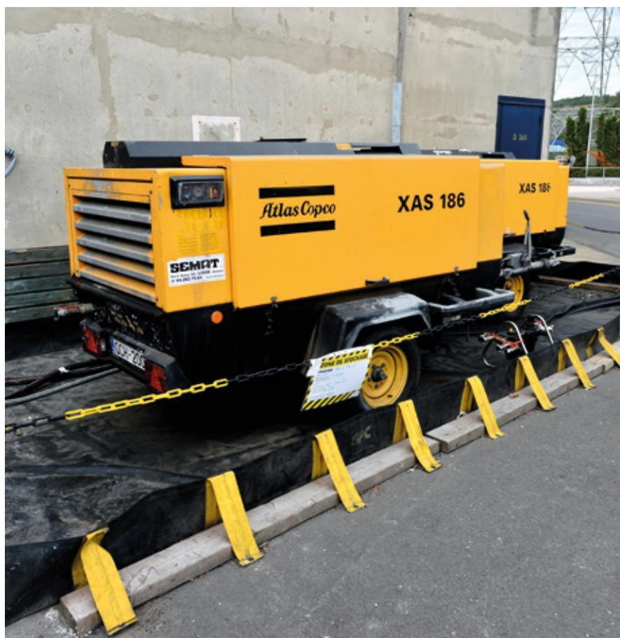
Encuvement mobile permettant d'assurer la prévention anti-pollution d'engin de chantier.
