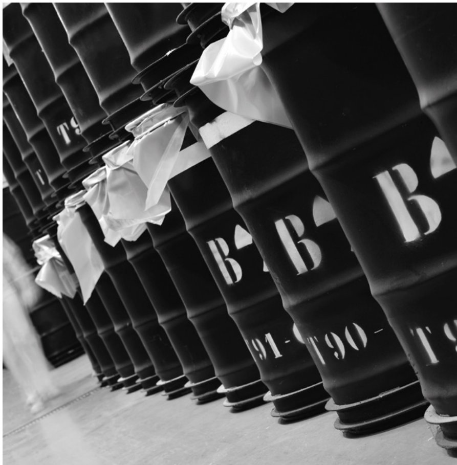
Waterfilters, laagradioactieve harsen en slib worden in speciale afvalvaten met beton gemengd.
